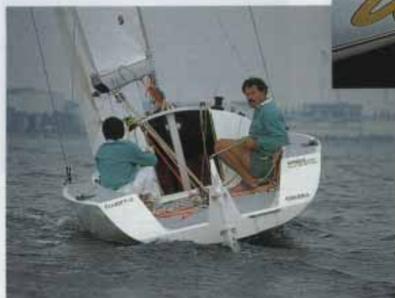
↑風速1~2m、微風時はスキッパーがコクピットに入るだけで微妙なヒールを調整できる。軽量艇ならではの楽しみかただ
